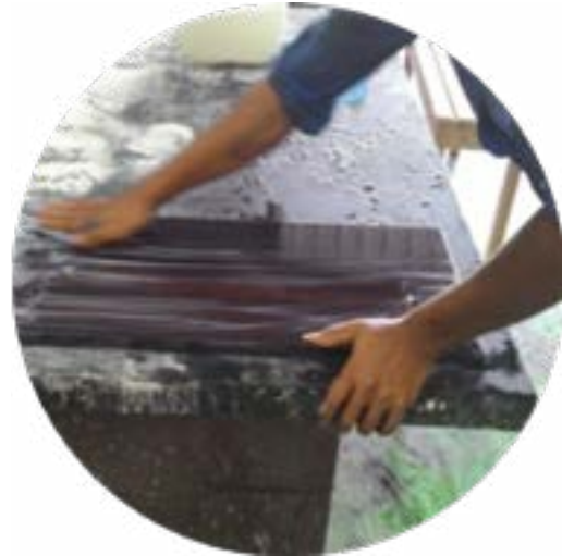
Fig 3.7.2 (vii): Wet sanding
